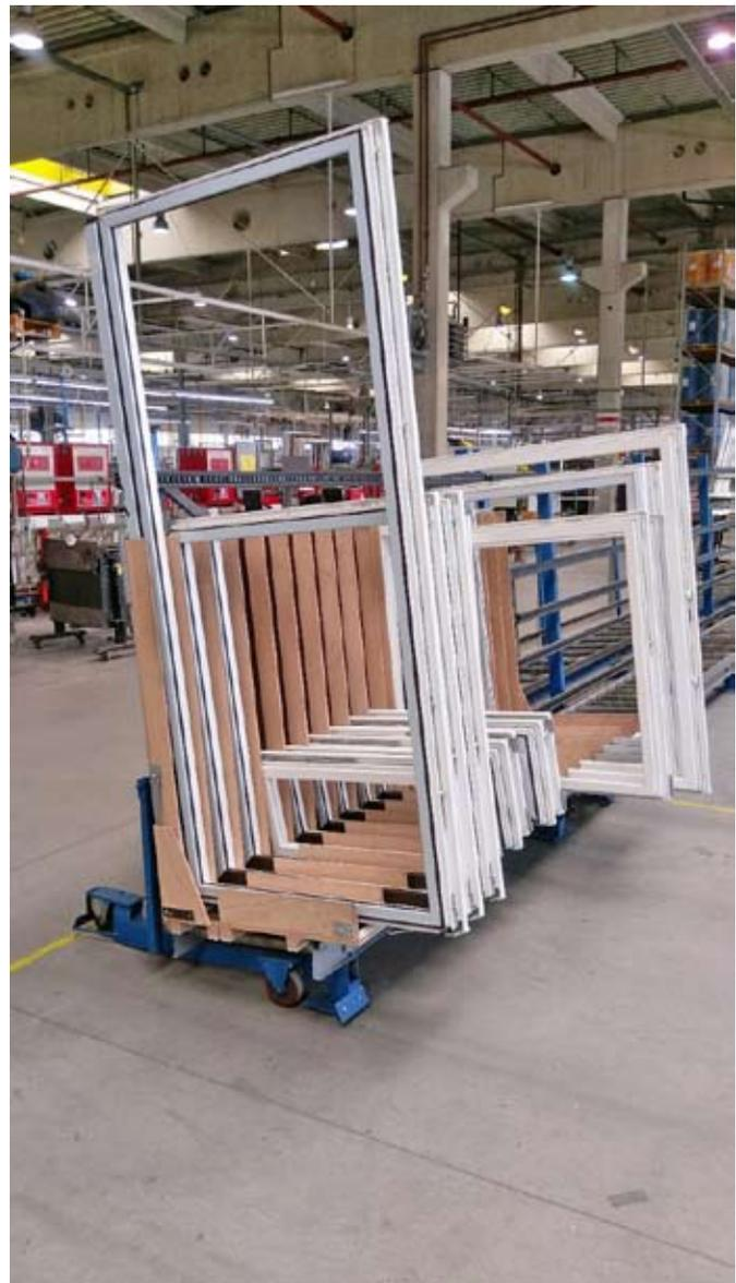
Bsp. Arbeitsplatzoptimierung -Einzelzugriff auf Flügelrahmen
